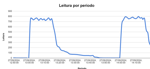
Figura 1. Gráfico da coleta de dados do sensor, com leituras de 0 (menor fluxo) a 800 (maior fluxo).
